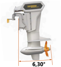
Fig. 59: Motor volledig omlaag gekanteld
