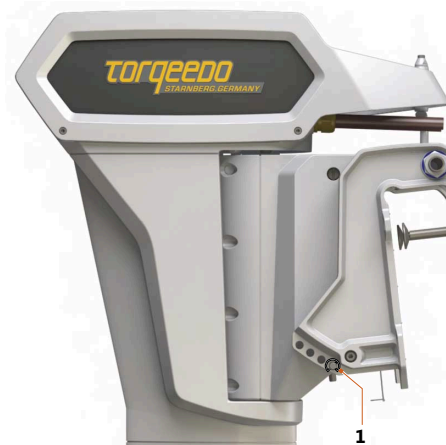
Fig. 14: Goupille de sécurité du boulon de stabilisation
