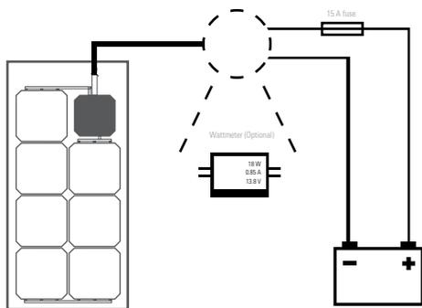
**ATTENZIONE:** il regolatore è protetto da correnti inverse (inversione accidentale della polarità nel collegamento alla batteria) solo se viene installato il fusibile in dotazione. Infatti in caso di inversione di polarità un diodo di bypass causa la bruciatura del fusibile esterno, evitando così che il circuito venga percorso dalla corrente inversa.
